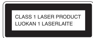
Este dispositivo está clasificado como producto LÁSER DE CLASE 1 según la norma IEC60825-1+A2:2001.
