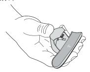
**2** アタッチメントのステレオヘッドホン/マイクプラグをワイヤレスコントローラーのステレオヘッドホン/マイク端子にしっかり挿し込む。
